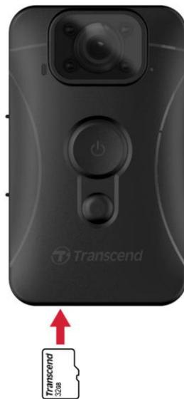
1. Inserire una microSD nell'apposito slot situato nella parte inferiore della camera.
