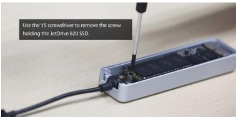
Utilizzare il cacciavite T5 per rimuovere la vite che tiene la JetDrive SSD.
