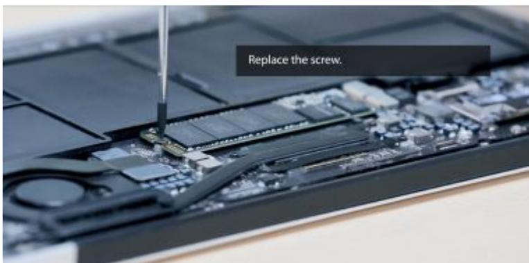
Befestigen Sie die JetDrive SSD mit der Schraube.
