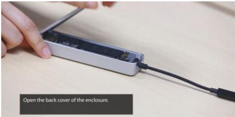
Öffnen Sie die Gehäuserückwand.
