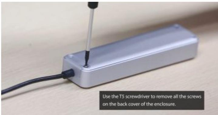
Utilisez le tournevis T5 pour retirer toutes les vis du couvercle arrière du boîtier.
