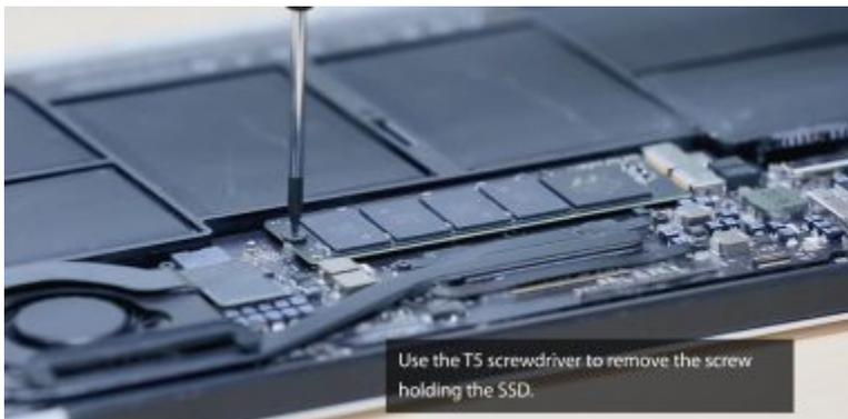
Utilisez le tournevis T5 pour retirer la vis de fixation du SSD.
