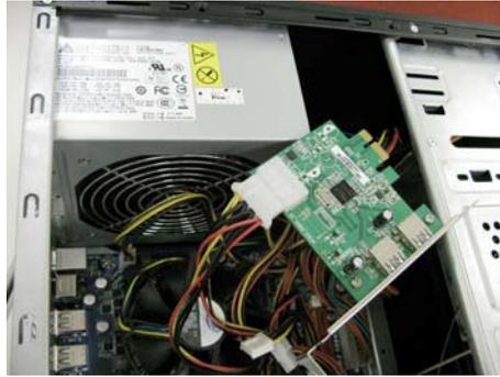
5. Stecken Sie die USB 3.0 Erweiterungskarte in den PCIe-Steckplatz und drücken Sie sie herunter, bis sie fest im Steckplatz sitzt.
