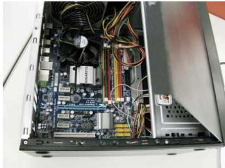
3. Wählen Sie einen PCI Express-Steckplatz, in den Sie die USB 3.0-Karte einbauen möchten (kurze und lange Steckplätze funktionieren beide) und entfernen Sie das Slotblech neben dem Steckplatz.
