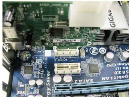
6. Befestigen Sie die USB 3.0 Erweiterungskarte an dem Computergehäuse mit den Schrauben des Gehäuses.
